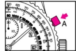
2. Interrumpir la medida presionando nuevamente el pulsador A. La medida se efectúa en horas (contador 1), minutos (contador 2), segundos y  $\frac{1}{5}$  de segundo (aguja 3).
