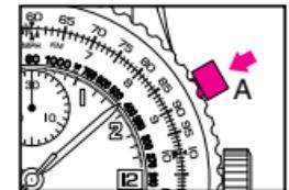
2. Для остановки хронографа еще раз нажмите на кнопку А. Показания об измеряемом отрезке времени можно прочитать: в часах (счетчик 1), минутах (счетчик 2), в секундах и в  $\frac{1}{5}$  доли секунды (стрелка 3).
