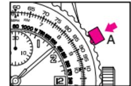
2. Arrêter la mesure en appuyant à nouveau sur le poussoir A. La mesure s'effectue en heures (compteur 1), minutes (compteur 2), en secondes et  $\frac{1}{5}$ e de seconde (aiguille 3).
