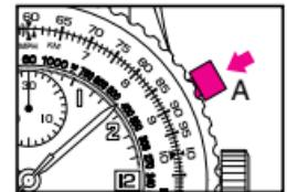
2. Zum Stoppen der Messung erneut Drücker A betätigen. Die Messung erfolgt in Stunden (Zähler 1), Minuten (Zähler 2), Sekunden und  $\frac{1}{5}$ -Sekunden (Zeiger 3).
