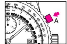
2. Interromper a medição pressionando novamente o pistão A. A medição é efectuada em horas (contador 1), minutos (contador 2), em segundos e em  $\frac{1}{5}^{\circ}$  de segundo (ponteiro 3).
