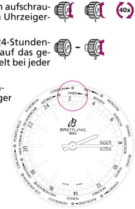
3. Die Krone in Position 3 ziehen. Die Uhr hält an, um eine sekundengenaue Zeiteinstellung vorzunehmen. Für die Stunden- und Minuteneinstellung die Zeiger vor- oder rückwärts bewegen unter Berücksichtigung der Anzeige der 24-Stunden-Scheibe. Um einen Datumswechsel zu vermeiden, Mitternacht nicht überschreiten.
