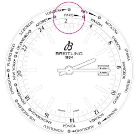
3. リューズを3の位置まで引き出すと、時報などに合わせて秒針まで正確に合わせられるよう、時計が停止します。リューズをどちらかの方向に回して、時・分針を現在の時刻に合わせます（24時間目盛リングは回転しますが、都市名リングは回転しません）。この時、日付が替わらないようにご注意ください。
