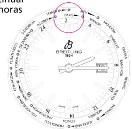
3. Puxar a coroa para a posição 3, o relógio pára para poder acertar a hora ao segundo. Rodar os ponteiros para a frente ou para trás, a fim de ajustar as horas e os minutos, tendo em conta a indicação do disco das 24h e, tendo o cuidado de não passar pela meia-noite para evitar que a data salte.
