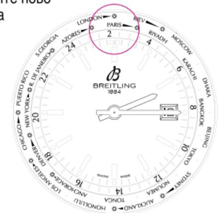
3. Выдвиньте головку в положение 3 – часы останавливаются, что позволит установить время с точностью до секунды. Вращая стрелки вперед или назад, отрегулируйте часы и минуты с учетом 24-часового способа отображения времени; постарайтесь не перейти за полночь, чтобы не переключилась дата.
