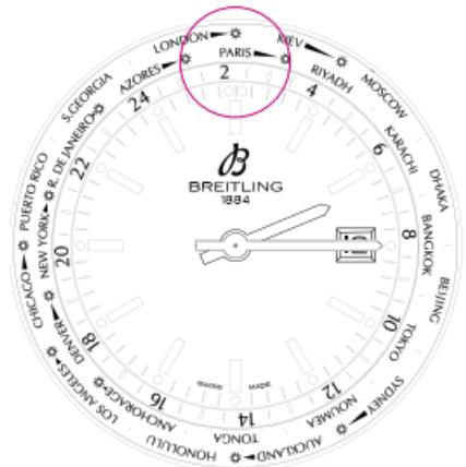
3. 將錶冠拉至3號位置，此時腕錶停止走動以調整至最精確的時間。向前或向後旋轉錶冠調整時針和分針，同時要注意24小時圓盤的指示，小心不要經過午夜時間，以防引起日期變更。
