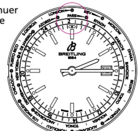
3. Tirer la couronne en position 3, la montre s'arrête pour pouvoir faire une mise à l'heure à la seconde. Faire tourner les aiguilles en avant ou en arrière pour ajuster l'heure et la minute en tenant compte de l'indication du disque des 24h et en veillant à ne pas passer par minuit pour éviter que la date saute.
