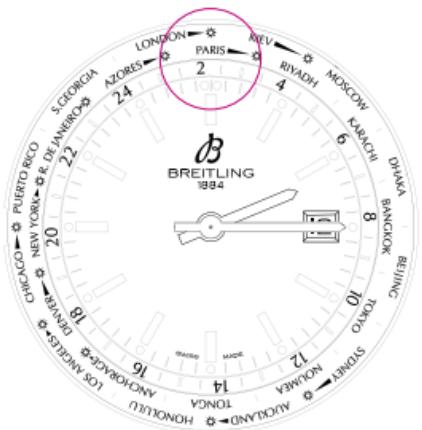
3. 将表冠拉至3号位置，此时腕表停止走动以调整至最精确的时间。向前或向后旋转表冠调整时针和分针，同时要注意24小时圆盘的指示，小心不要经过午夜时间，以防引起日期变更。
