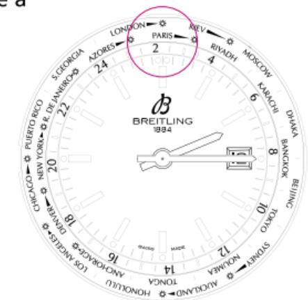
3. Estrarre la corona portandola in posizione 3: l'orologio si ferma per consentire di regolare l'ora al secondo. Ruotare le lancette avanti o indietro per regolare l'ora e il minuto tenendo conto dell'indicazione del disco delle 24h e badando bene a non oltrepassare la mezzanotte per evitare lo scatto della data.
