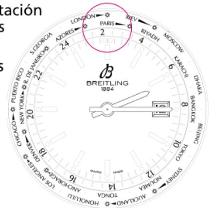
3. Tirar la corona hasta la posición 3: parada el reloj para poder efectuar la puesta en hora al segundo exacto. Girar las agujas hacia delante o hacia atrás para ajustar la hora y el minuto, teniendo en cuenta la indicación del disco de las 24h y procurando no sobrepasar la posición de medianoche para evitar que salte la fecha.
