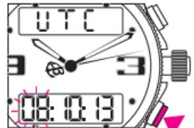
Una presión corta en el pulsador B: las H y los MIN del display parpadean sucesivamente.
