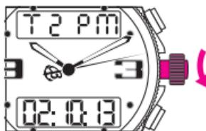
В случае необходимости корректировка осуществляется при помощи вращения головки часов. Корректировка минут проводится в 15-минутных интервалах для того, чтобы разделение временных поясов соответствовало различным частям света. Затем вернуть головку в позицию 1.
