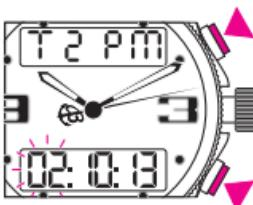
Die Zeit wird durch kurze Betätigung des Drückers A wahlweise im 24H- oder AM/PM-Modus angezeigt.
