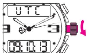
Каждая регулировка осуществляется за счет вращения головкой часов. Примечание: Корректировка минут проводится в 15-минутных интервалах. Вернуть головку в позицию 1.
