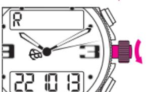
Die jeweilige Synchronisation der analogenen H, MIN und SEK (Zeiger) erfolgt durch Drehen der Krone. N.B. Die SEK bewegen sich nur im Uhrzeigersinn vorwärts. Die Krone in Position 1 zurückstoßen.
