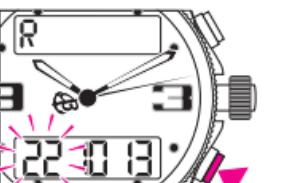
Pression courte sur le poussoir B: successivement, les heures, les minutes et les secondes (les H, les MIN et les SEC) de l'affichage clignotent.
