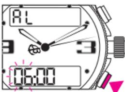
Durch kurze Betätigung des Drückers B blinken die H und die MIN nacheinander auf der Anzeige.
