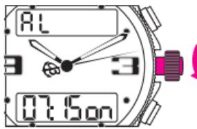
Les réglages respectifs des H et des MIN de l'alarme-réveil s'opèrent par rotation de la couronne. Repousser la couronne en position 1. L'alarme est activée.
