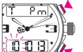
После короткого нажатия на кнопку А выбрать время или в 24-часовом цикле или в режиме AM/PM. В режиме AM/PM, коротко нажав на кнопку А, верхний дисплей можно затемнить.
