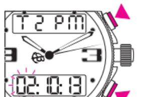
プッシュボタンBを短く1回押すとタイマーのデジタル時表示（下部デジタル表示窓）が点滅します。リューズを回してタイマーのデジタル時表示を合わせます。プッシュボタンBを短く1回押します。同様にしてタイマーのデジタル分、秒表示を合わせます。最後にリューズをニュートラル位置 (1) に押し戻します。
