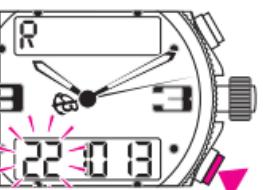
После короткого нажатия на кнопку B на дисплее последовательно друг за другом появляются мерцающие показатели часов, минут, секунд (H, MIN, SEK).
