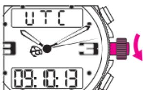
リューズを回してデジタル時表示を合わせます。pusshボタンBを短く1回押してデジタル分表示を点滅させ、リューズを回してデジタル分表示を合わせます（分表示は15分単位で変わります）。最後にリューズをニュートラル位置（1）に押し戻します。
