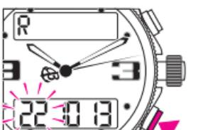
Durch kurze Betätigung des Drückers B blinken die Stunden, Minuten und Sekunden (H, MIN und SEK) nacheinander auf der Anzeige.
