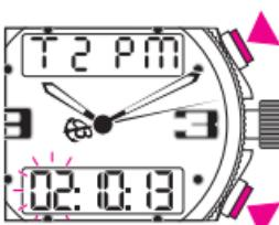
L'heure peut être affichée en mode 24H ou AM/PM par une pression courte sur le poussoir A.
