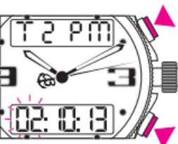
Se puede obtener la indicación de la hora en modalidad 24H o AM/PM mediante una presión corta en el pulsador A.
