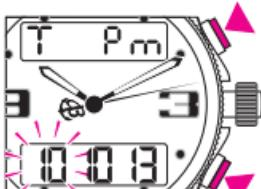
Durch kurze Betätigung des Drückers A kann die Zeitangabe nach dem Modus 24H oder AM/PM gewählt werden. Beim AM/PM-Modus kann die Anzeige auf dem oberen Display durch Betätigung des Drückers A ausgeblendet werden.
