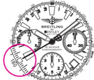
*Exemple 2:* S'il faut 36 secondes pour parcourir un kilomètre ou un mile, la vitesse moyenne est de 100 km/h, respectivement 100 mph.
