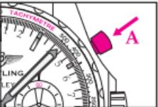
2. Interrumpir la medida presionando nuevamente el pulsador A. La medida se efectúa en horas (contador 1), minutos (contador 2), segundos y  $\frac{1}{8}$  de segundo (aguja 3).
