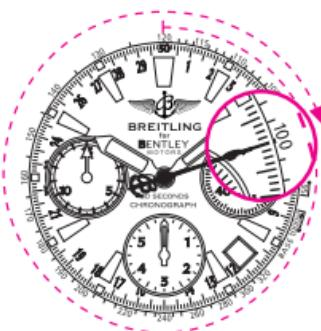
n.B. Utilizada conjuntamente con el cronógrafo «30 segundos», esta escala taquimétrica facilita la medida de velocidades situadas entre 95 km/h (o mph) y 320 km/h (o mph). Por consiguiente, el tiempo de observación se situará entre 11 y 38 segundos.
