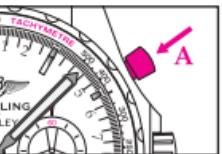
2. 欲結束計時，再次按下A鈕即可。計時的結果以小時（1號累計器）、分鐘（2號累計器）、秒鐘與八分之一秒單位（3號指針）顯示於錶面。
