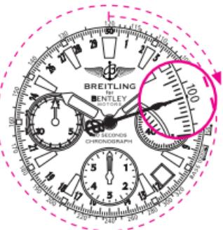
n.B. Cette échelle tachymétrique, utilisée en conjonction avec le chronographe «30 secondes», est spécialement adaptée à la mesure de vitesses élevées situées entre 95 km/h (ou mph) et 320 km/h (ou mph). Par conséquent, le temps d'observation est limité de 11 à 38 secondes.
