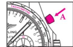
2. Para interrumpir la medida, presionar nuevamente el pulsador A. Para reanudar la medida, presionar el pulsador A. Esta operación permite la acumulación de varios tiempos cortos.
