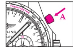
2. Для прекращения измерения следует опять нажать кнопку **A**. Таким образом можно измерить несколько отрезков времени и суммировать их.
